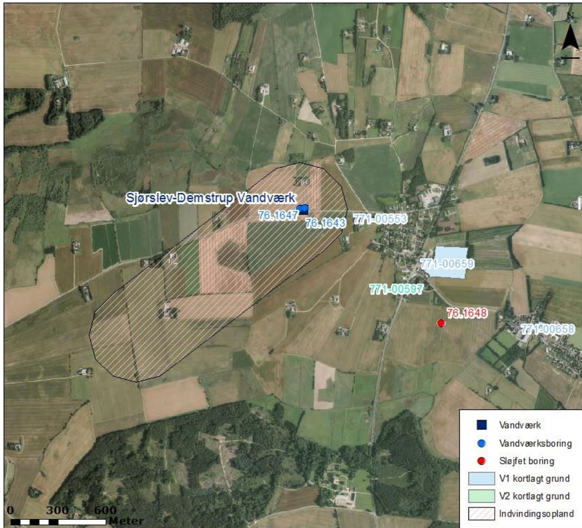
Figur 3.2 Sjorslev-Demstrup Vandværks indvindingsopland med placering af vandværket, boringer og V1 og V2 kortlagte lokaliteter.
